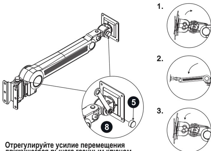
Отрегулируйте усилие перемещения движущегося рычага гаечным ключом.
