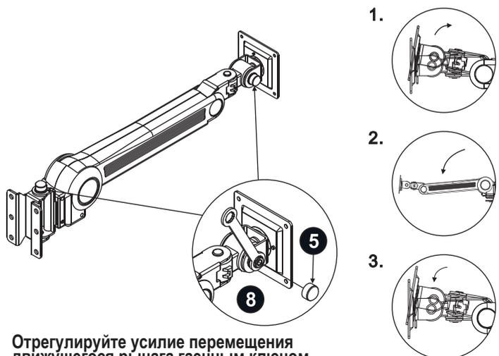
Отрегулируйте усилие перемещения движущегося рычага гаечным ключом.
